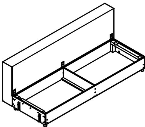
3. Перевернуть сиденье. Установить опоры роликовые согласно схеме. Фиксировать саморезами 3,5x35. Наклеить на опоры деревянные пяточки войлочные по 2 шт.
